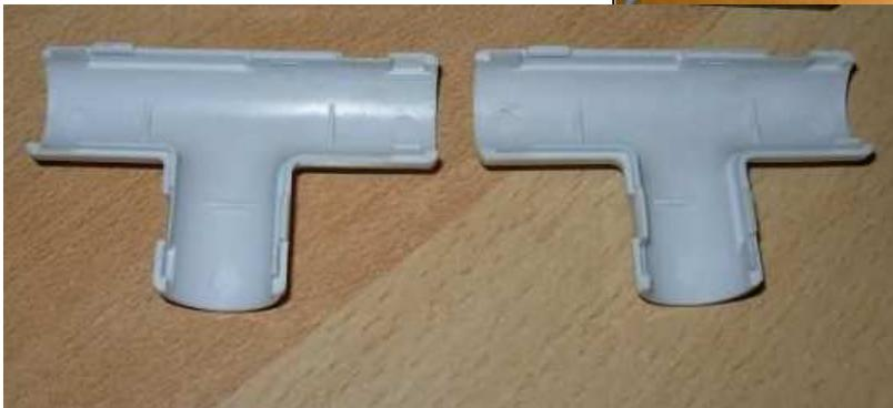
Con l'ausilio di una T, e tre spezzoni di tubo da 16 mm di diametro, possiamo irrigidirla.
